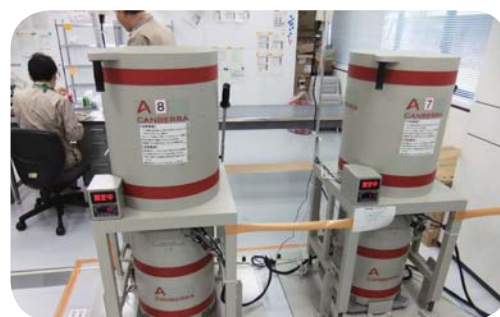
モニタリング検査に使用するゲルマニウム半導体検出器
